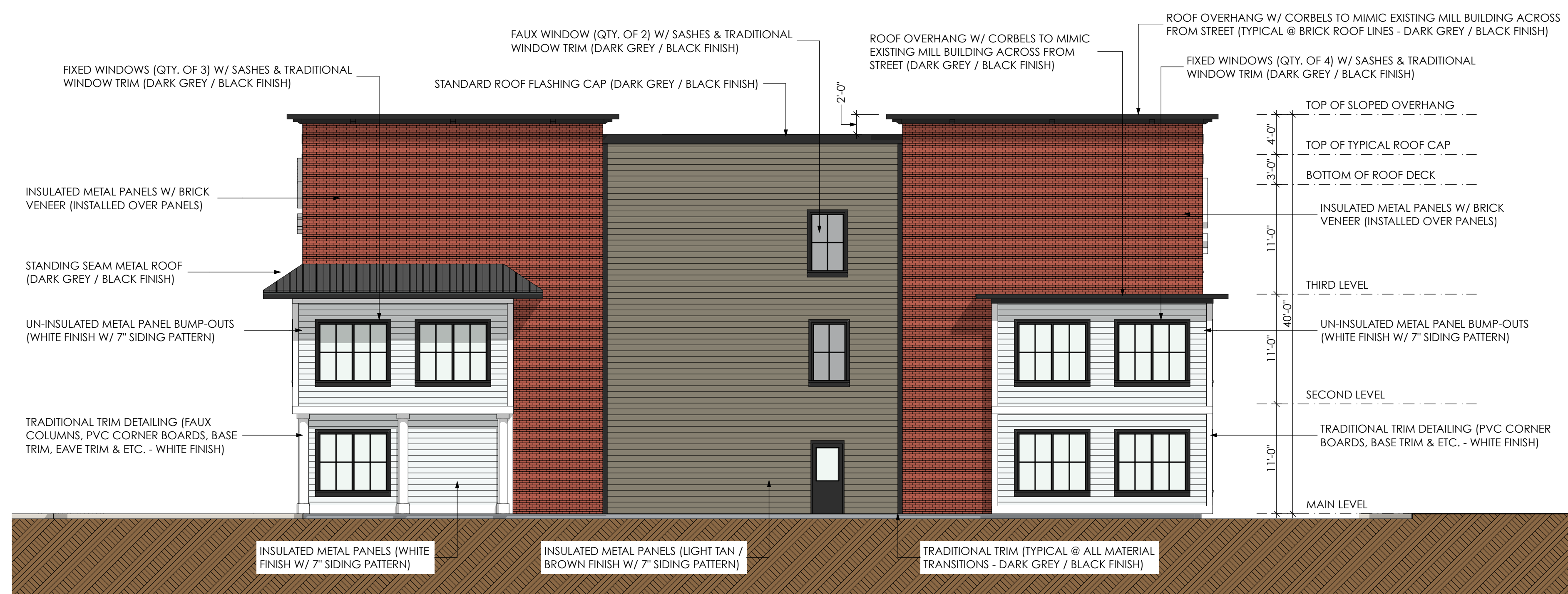
1 SOUTH ELEVATION SCALE: 1/8" = 1'-0"
